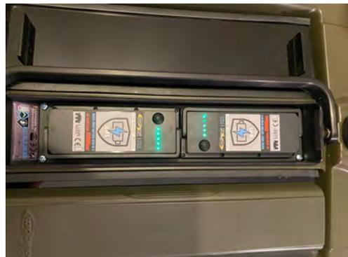
Deckel wieder ordentlich, das umlaufende Dichtungsband sorgt für die Wasserdichtigkeit, verschließen.
