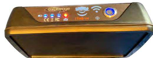
**Hinweis: Die Transmitterbox hat einen internen Akku der ca 14 Std Laufzeit hat. Jede LED ist ca 25% (ca 3 Std) Akkukapazität. Es ertönt ein Alarm-Ton der bei einer Weiternutzung immer intensiver wird und bei Erreichen der Spannungsuntergrenze von 9 Volt geht die Transmitterbox aus um den Akku vor einer Tiefentladung zu schützen**
